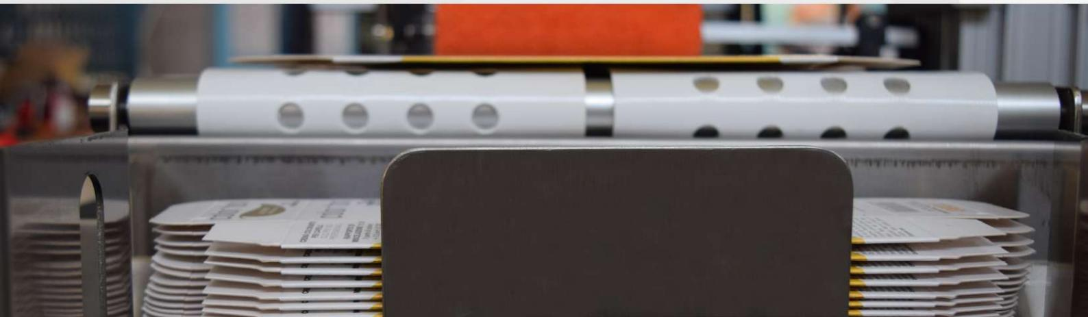
Sistema di raccoglitura automatico per astucci piani, buste, cartoncini con magazzino di carico regolabile a dimensione e spessore prodotto. Struttura in acciaio e alluminio. Gestione e controllo tramite PLC e interfaccia operatore tramite Touch-screen 7" a colori. Tutti i motori sono Sincronizzati e controllati dal pannello operatore.
